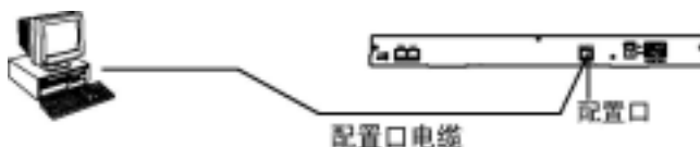
图 4-1 通过 Console 口搭建本地配置环境
